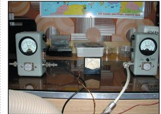
mes essais ! J'ai contrôlé le calibrage de l'appareil de mesure du PA !
